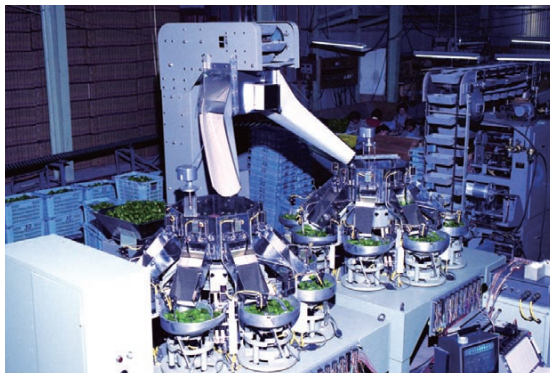
1972年●ピーマンの袋詰め作業の効率化を機に、重量や形状にバラツキがあっても定量計量できる「コンピュータスケール」を世界で初めて開発。現在、世界シェアは約70%
