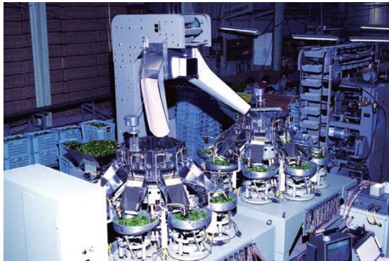
1972年●ピーマンの袋詰め作業の効率化を機に、重量や形状にバラつきがあっても定量計量できる「コンピュータスケール」を世界で初めて開発。現在、世界シェアは約70%
